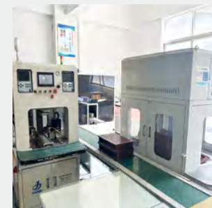
自动点焊单元 Automatic Cell Spot Welding
