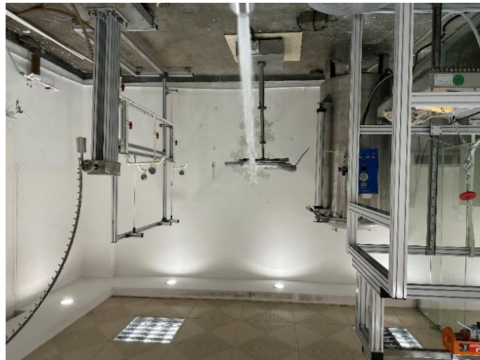
IPX6 water-jet test
